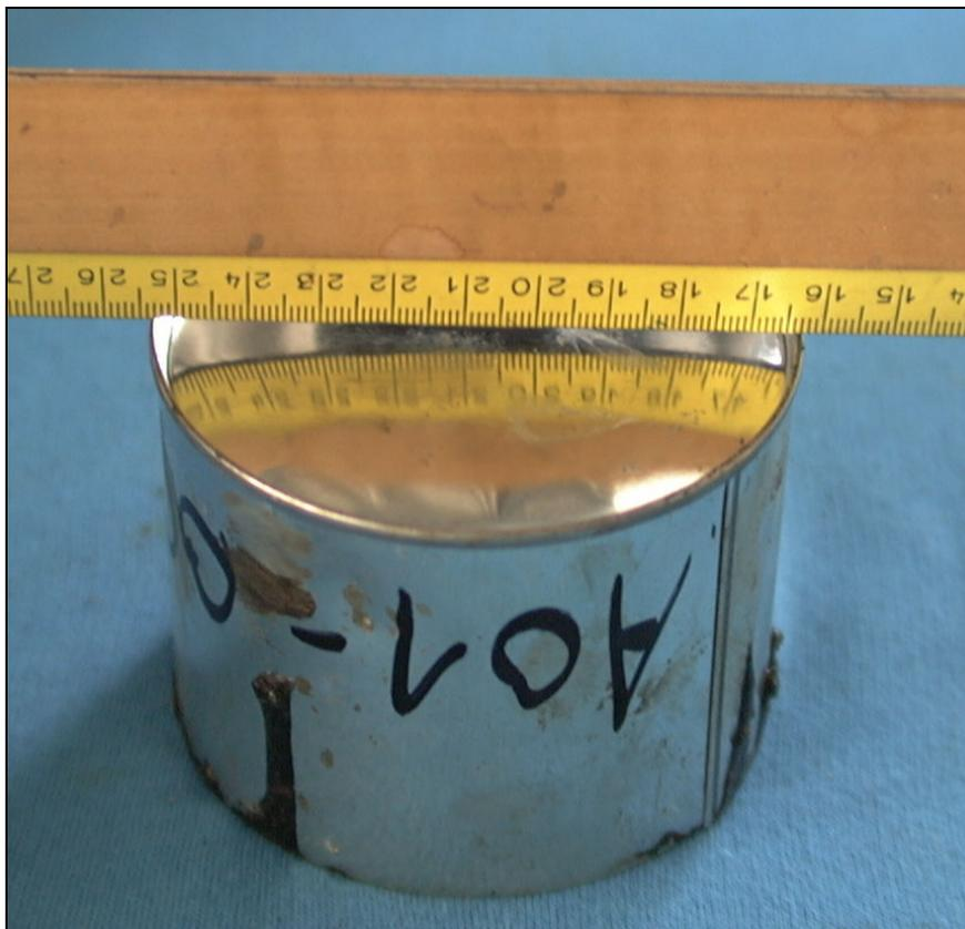
Abb. 4.12 Verformter Boden einer Giessform in welcher Gussasphalt-Zylinder auf der Baustelle gegossen wurden.
