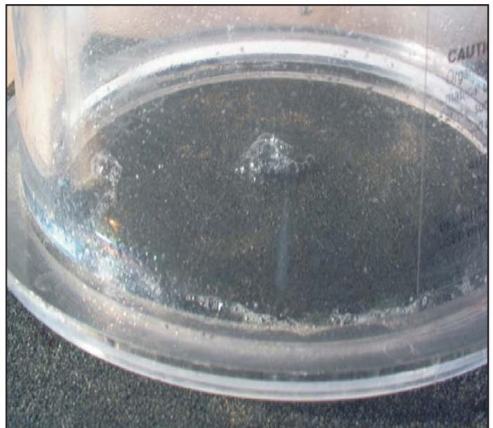
Schaumbildung unter Vakuum infolge Undichtigkeit
