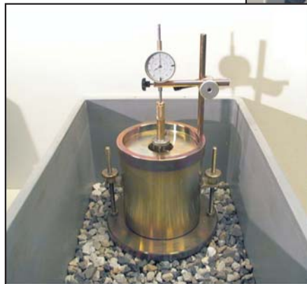
Wasserlagerung für CBR_2
