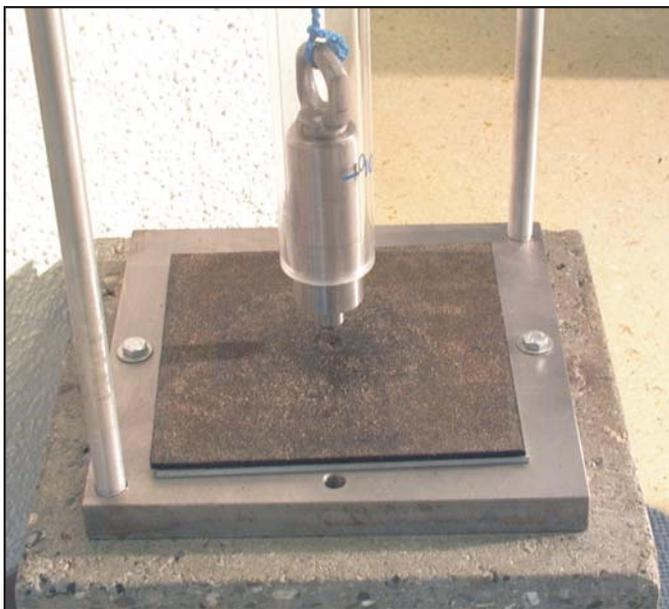
Percuteur tombant sur l'éprouvette LBP
