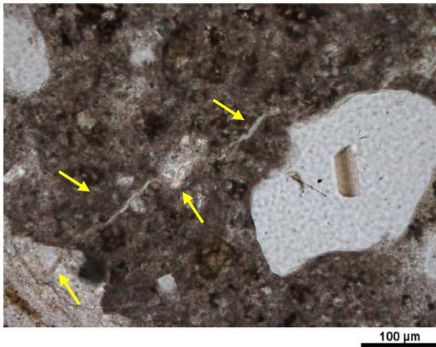
Abb. 58 Mikroaufnahme eines Rissystems im Zementstein der dotierten Referenz-Betonserie **B-K** nach 360 Tagen Auslagerungszeit (parallele Polarisatoren, Dünnschliff, Polarisationsmikroskop).
