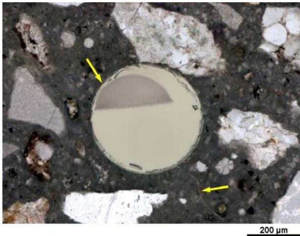
a) Luftpore mit AKR Reaktionsprodukten (parallele Polfilter).
