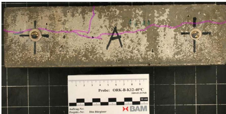
Abb. 66 Betonprisma der **B-K** Serie nach 360 Tagen Auslagerung mit dem durch AKR verursachten Rissystem (die Risse sind zur Verdeutlichung farbig nachgezeichnet).
