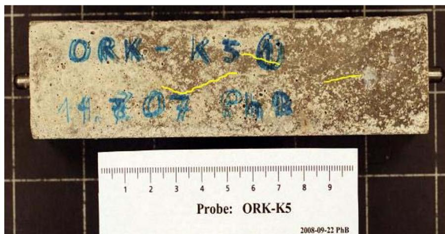
Abb. 41 Mörtelprisma der **M-K** Serie mit Rissen nach der Auslagerungszeit von 360 Tagen.
