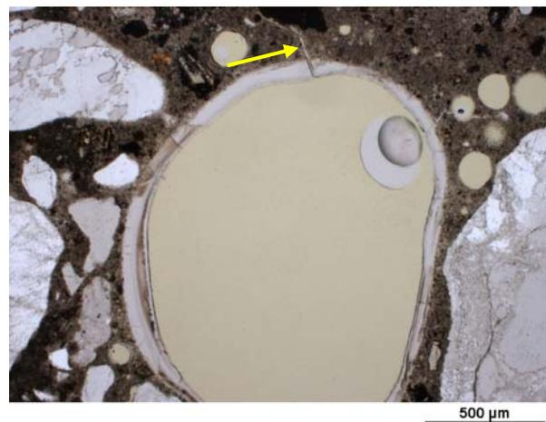
Abb. 74 Luftpore mit Reaktionsprodukten an Zementstein/Luftpore der Italienisch II trasshaltigen Serie **B-KT3-60**.
