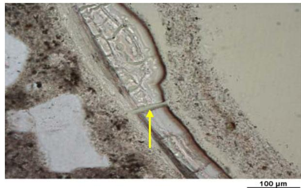
Abb. 59 Lichtmikroskopische Aufnahmen der in den Luftporen enthaltenen gelförmigen AKR-Reaktionsprodukte der Referenz-Betonserie **B-K** nach 360 Tagen Auslagerungszeit (parallele Polarisatoren, Dünnschliff, Polarisationsmikroskop).
