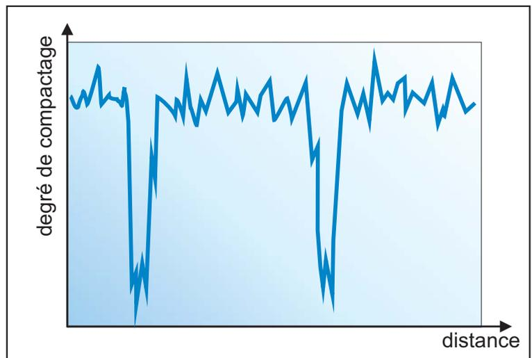
Nids de gravier réguliers dans l'AC T à cause du vidage complet de la trémie de la finisseuse
