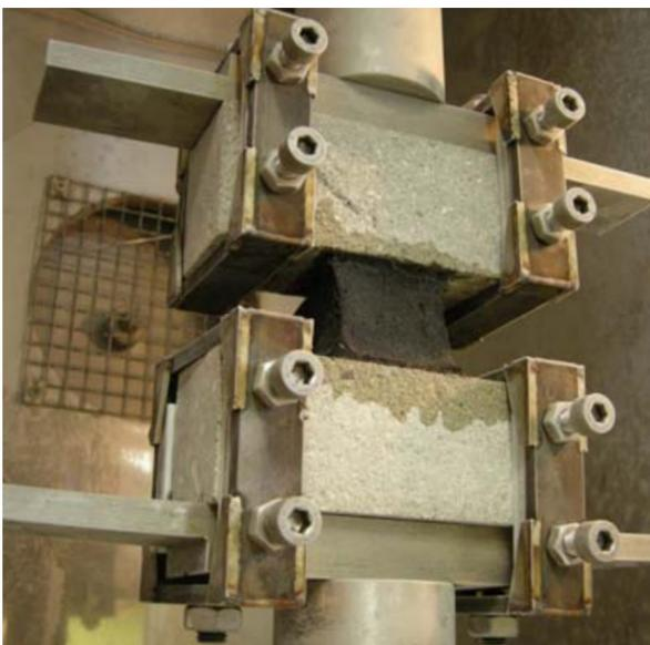
Probekörper in Universalprüfmaschine
