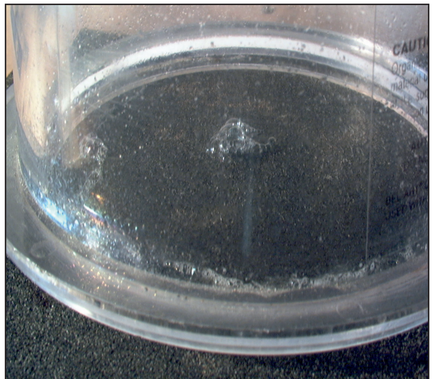
Schaumbildung unter Vakuum infolge Undichtigkeit
