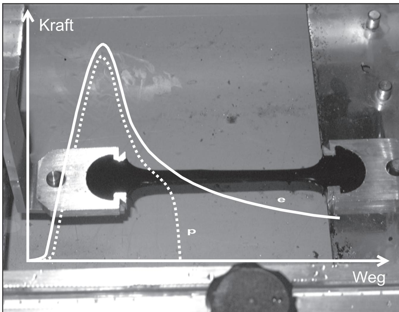
Die Fläche unter der Kraft-Weg-Kurve (=Arbeit) ist ein Mass für die Kohäsion des Bindemittels.
