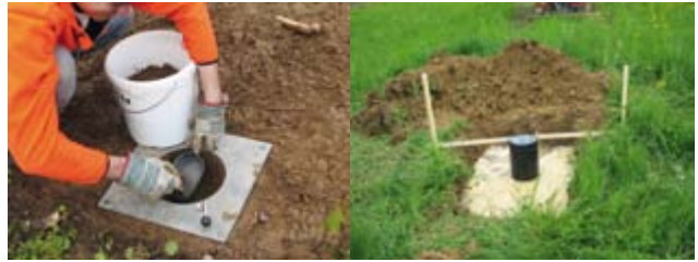
6: Sandersatzmethode zur Bestimmung der Raumdichte (links) und Sickergrube zur Bestimmung des in situ k-Werts im Lösslehm (Dammaufstandsfläche).
