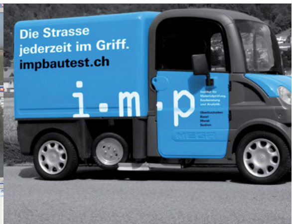
Kleines Seitenkraft-Messfahrzeug (SKM) zur Bestimmung der Griffigkeit bei Nässe.
