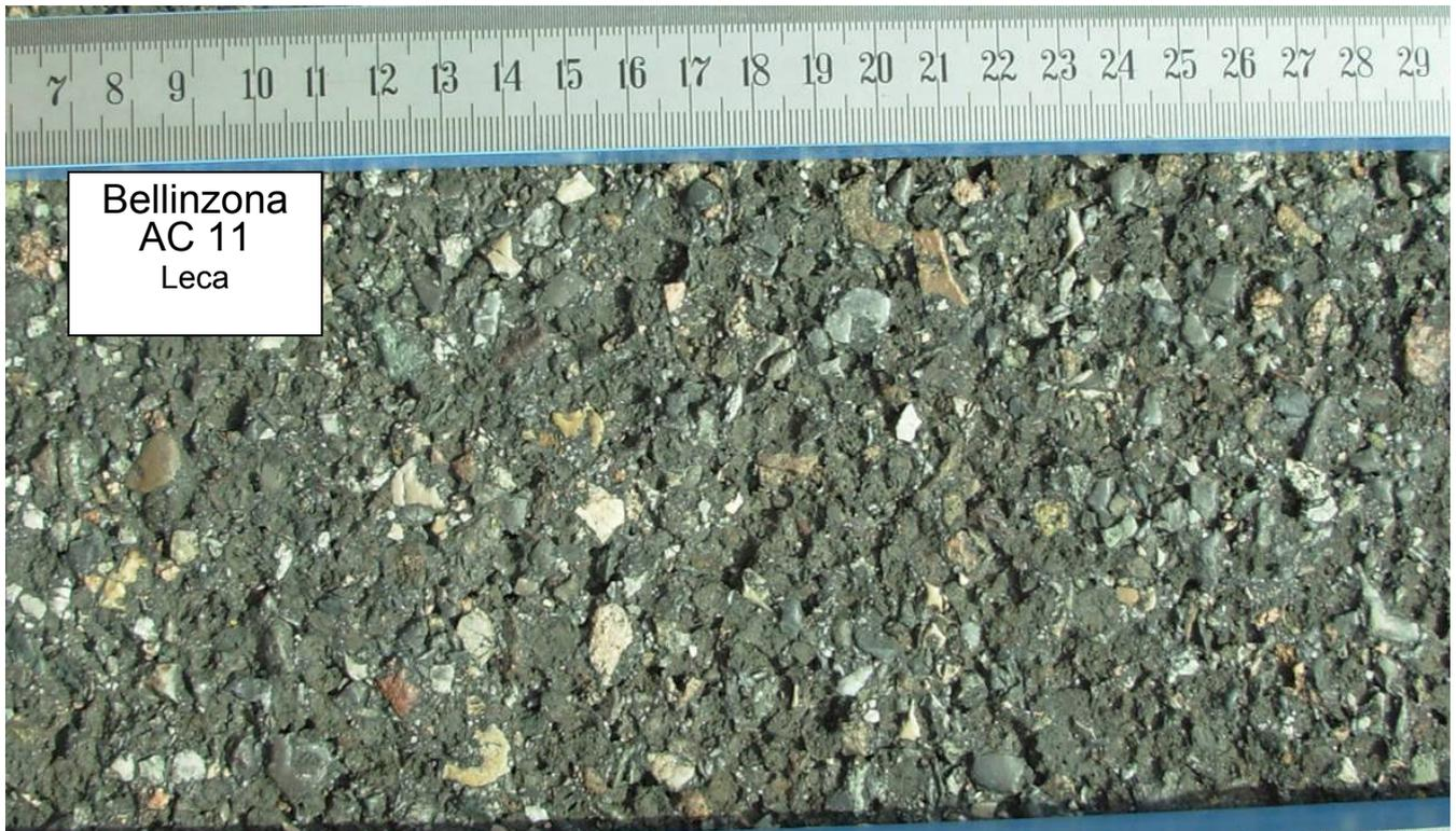
Radspur rechts: Der Belag scheint sehr abgenutzt aber ohne Spurrinnen. Es wird viel Kornausbruch beobachtet und besonders deutliche runde Löcher durch Leca Verlust. Die Radspuren sind verschmutzt, der seltene Leca ist abgeschliffen, die Gesteine sind poliert. Ausserhalb der Radspuren sind die Körner kantig und der Leca ist nicht ausgebrochen.
