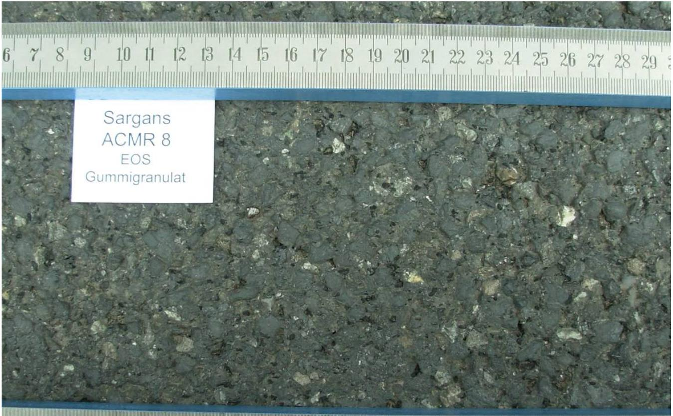
Radspur rechts: die EOS Eisenschlackenkörner sind gut sichtbar da sie glänzen, der Gummi löst sich (kleine Löcher) und lässt sich mit den Fingern herauszupfen, grössere Löcher deuten auf 8er-Kornausbruch.
