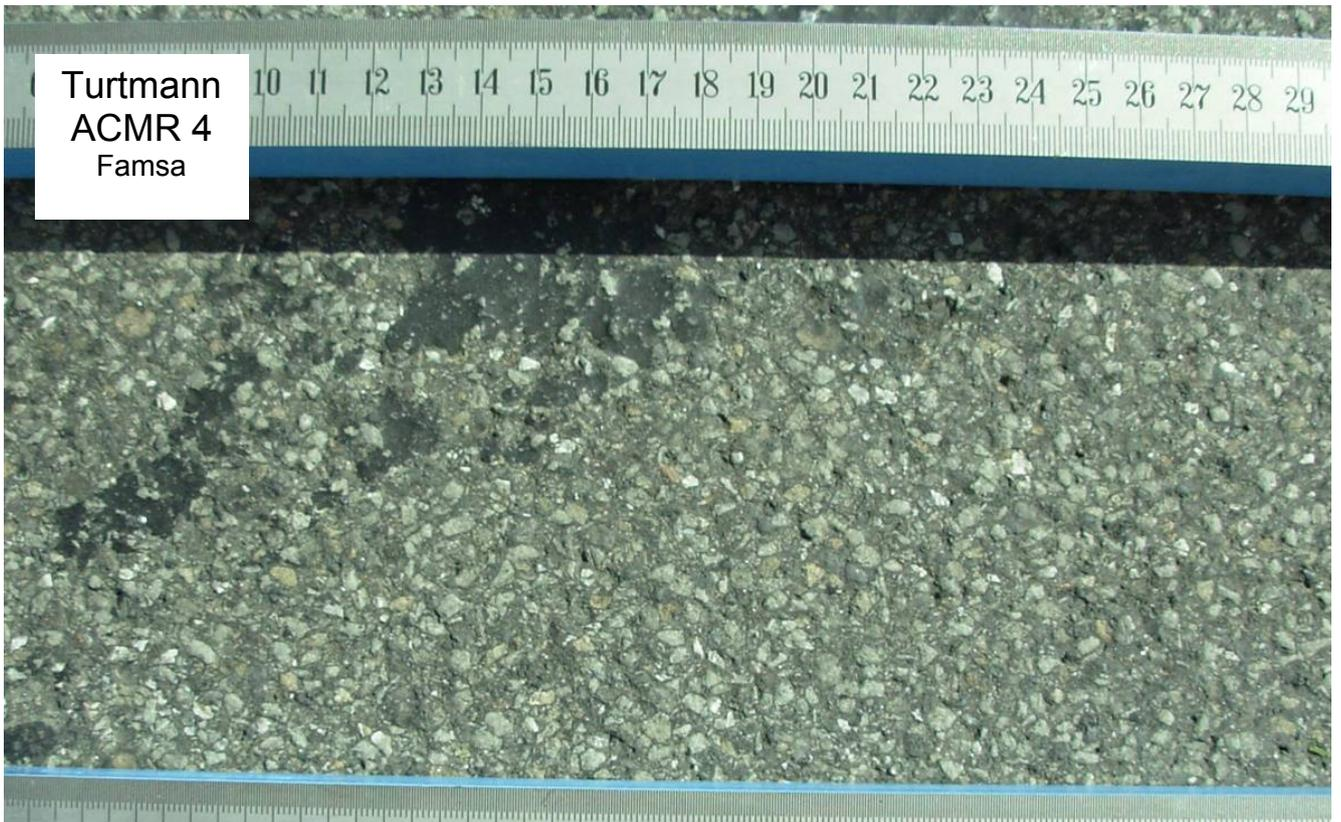
Radspur rechts; Der Belag zeigt viel Schmutz, darunter Ölflecken. Die Körner sind abgeschliffen und brechen zum Teil aus.
