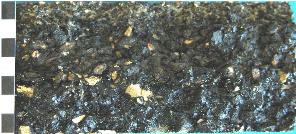
Der Schmutz in der oberen Schicht verhindert die Schallabsorption weitgehend. Gleichzeitig ist eine gewisse Selbstreinigung zu beobachten (Anhang 11), da im Vergleich zu der unbefahrenen Belagsoberfläche, der Bereich der Radspur durch zahlreiche Poren gekennzeichnet ist. Diese Poren tragen zur Reduktion des «air pumping»-Effektes, sodass im Endeffekt der verstopfte PA 4 akustisch wirksam bleibt.
