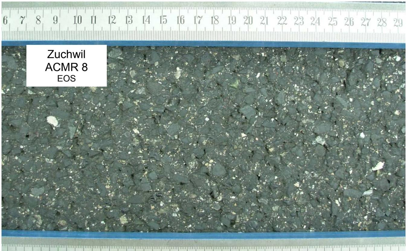
Radspur rechts; die EOS Eisenschlackenkörner sind gut sichtbar da sie glänzen, die 8er-Körner sind abgeschliffen. Es wurde nur sehr wenig Kornausbruch festgestellt.
