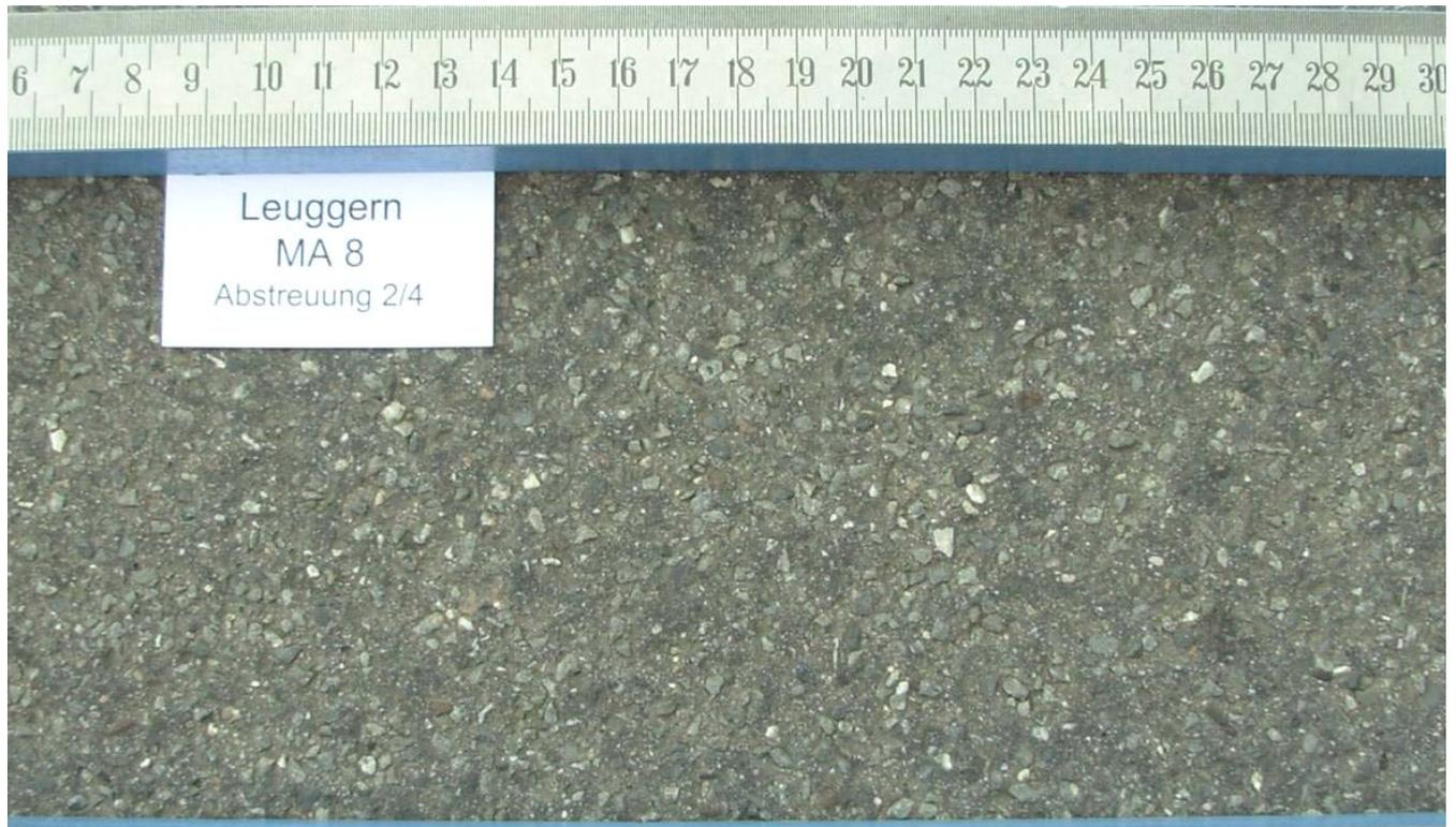
Rechte Radspur: Der Belag ist sehr dicht. In den Radspuren wird etwas Schmutz und Kornausbruch beobachtet.
