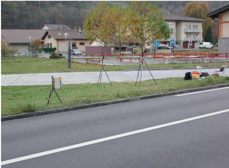
Messanordnung für die statistische Vorbeifahrtmethode: Geschwindigkeitsmessgerät, Mikrophon in 7.5 m und 5 m Distanz, Messgeräte und PC (von links nach rechts).
