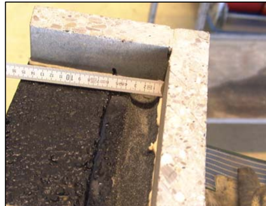
Abbildung 10: Prüfung der Wärmestandfestigkeit beim System A
