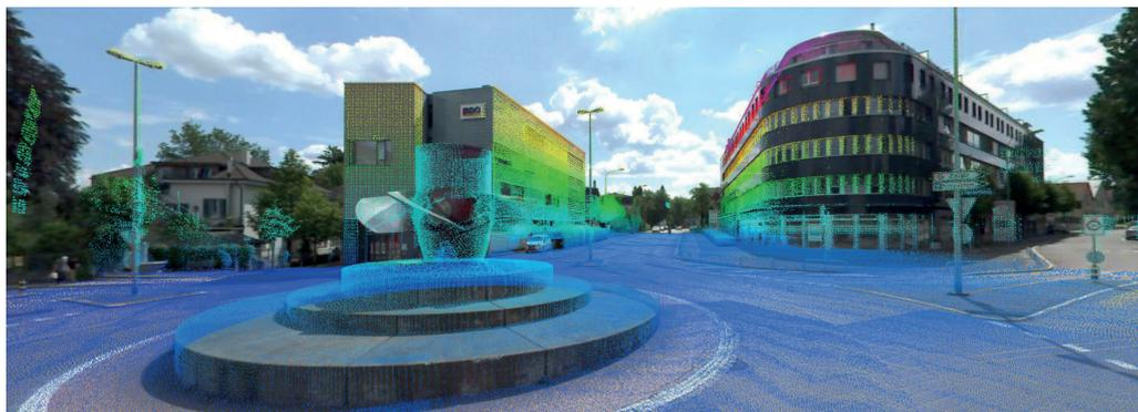
Bei der Messung entstehen dreidimensionale 360-Grad-Abbildungen des kompletten Straßenraums. Diese sind die Grundlage für digitale Geländemodelle.
