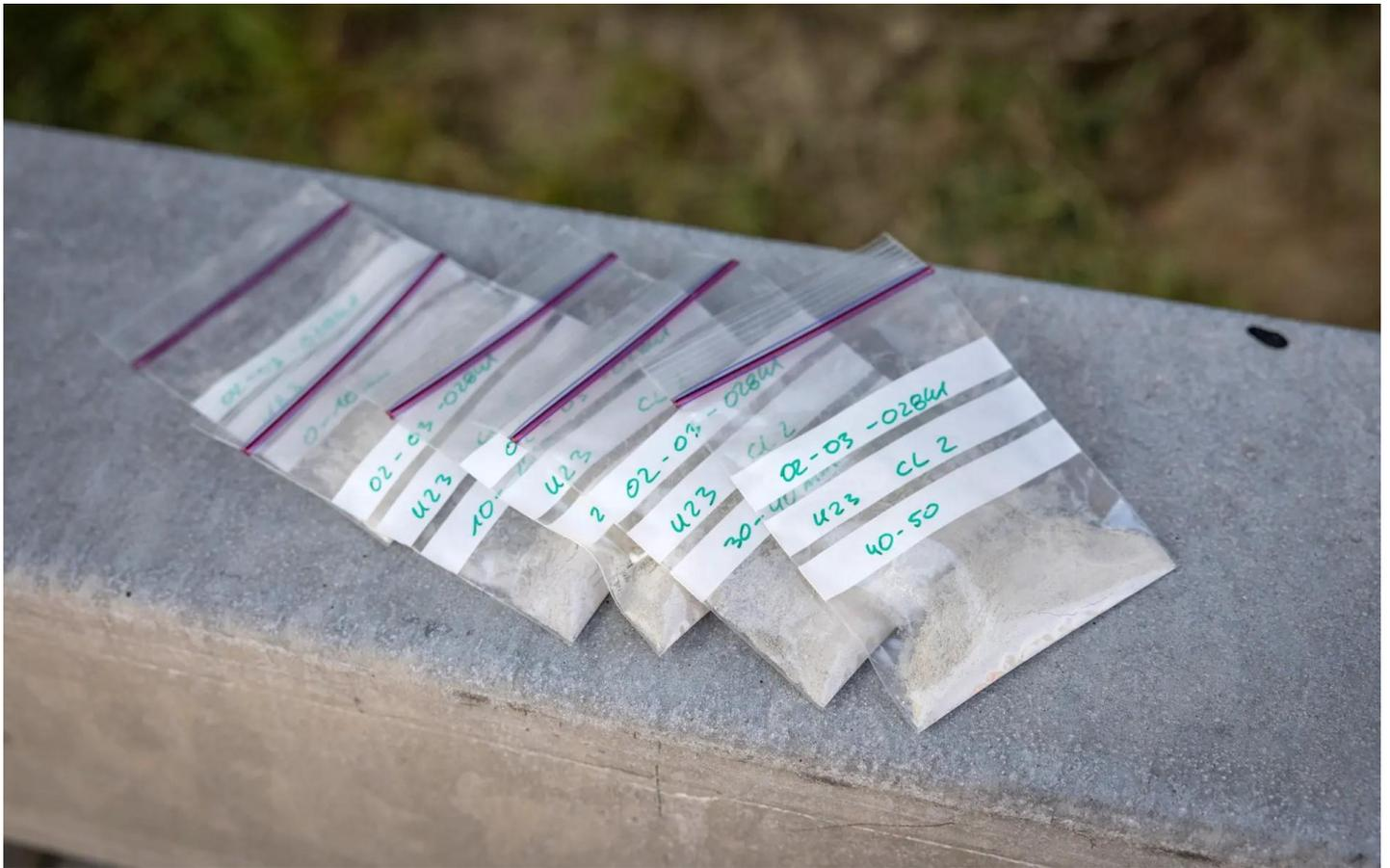
Der Bohrstaub wird für die Laboranalyse verpackt.
