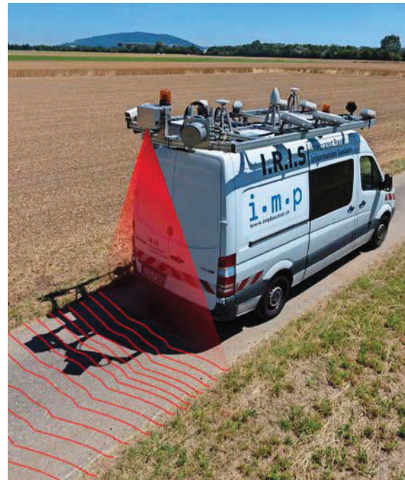
4.0 auch in der Schweiz: Rundumlaser und digitale Kameras erfassen bei Fahrgeschwindigkeiten bis zu 80 km/h den Straßenraum millimetergenau
