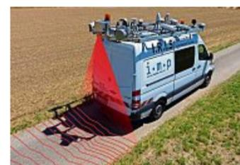
Messprinzip der laserbasierten Erfassung der Strassen-Oberfläche. z.Vg.
