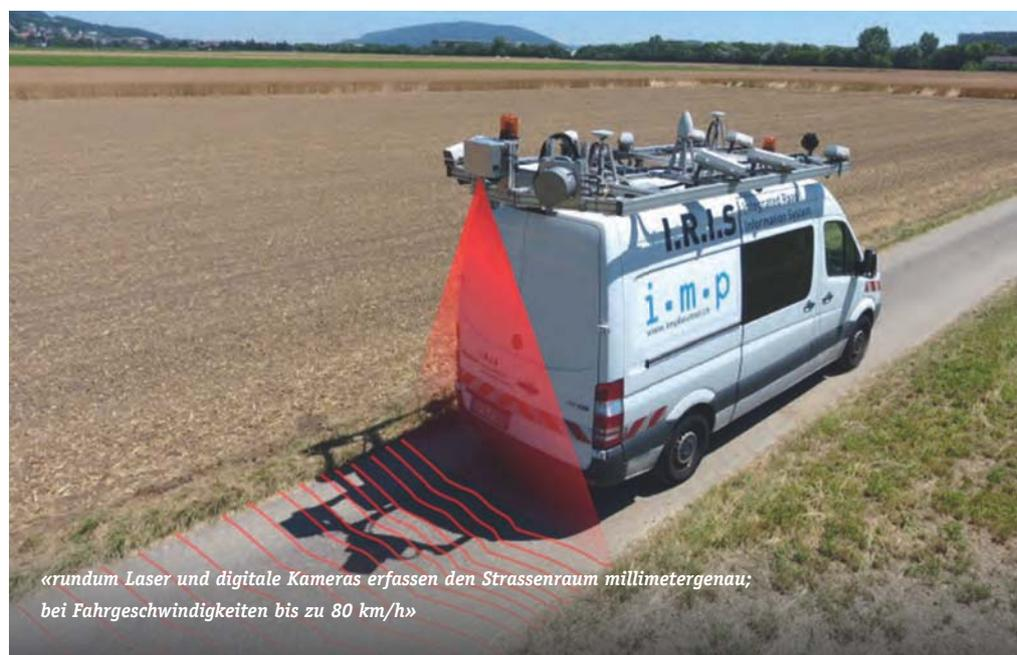
«rundum Laser und digitale Kameras erfassen den Strassenraum millimetergenau; bei Fahrgeschwindigkeiten bis zu 80 km/h»
