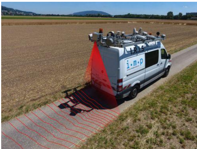
2/2 Bild: z.V.g. Rundum Laser und digitale Kameras erfassen den Strassenraum millimetergenau; bei Fahrgeschwindigkeiten bis zu 80 km/h.
