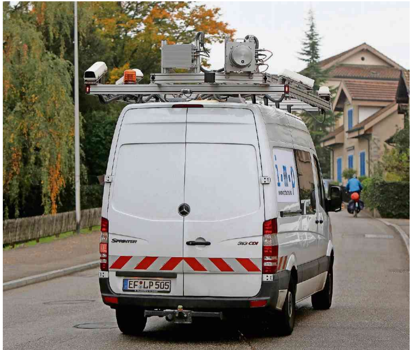
Das Fahrzeug, das den Strassenzustand misst, ist in den nächsten Tag in Olten unterwegs.
