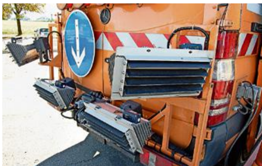
Am Heck sind mehrere Blitze montiert, die für ausreichend Licht sorgen.
