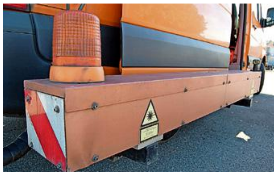
Die Laser auf der Seite messen die Längsebenheit.
