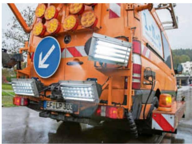
Teures Technikwunder: Am Messfahrzeug sind diverse Vorrichtungen montiert, um den Strassenzustand detailliert zu erfassen.
