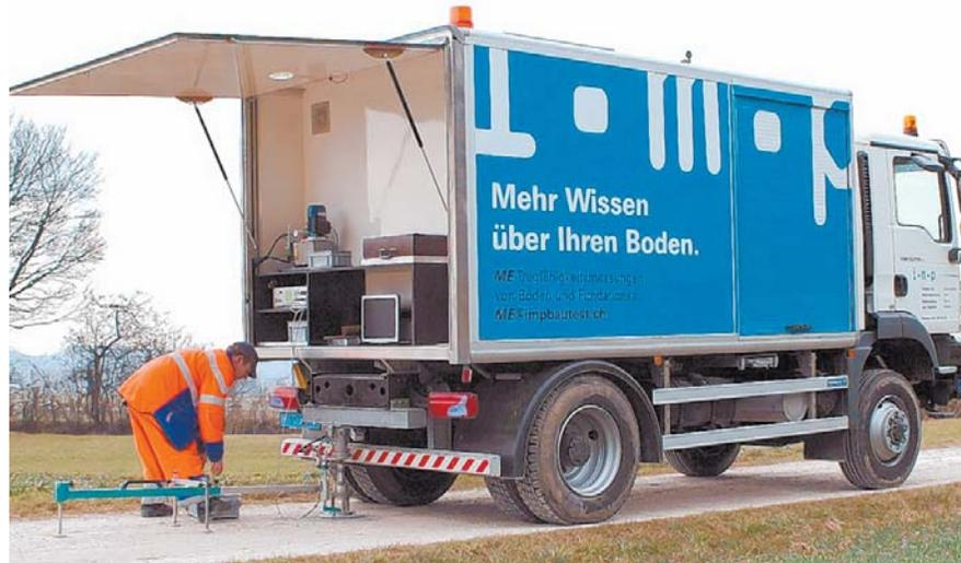
Das neue ME-Messfahrzeug der IMP misst die Tragfähigkeit von Böden und Fundationsschichten vollautomatisch. zvg
