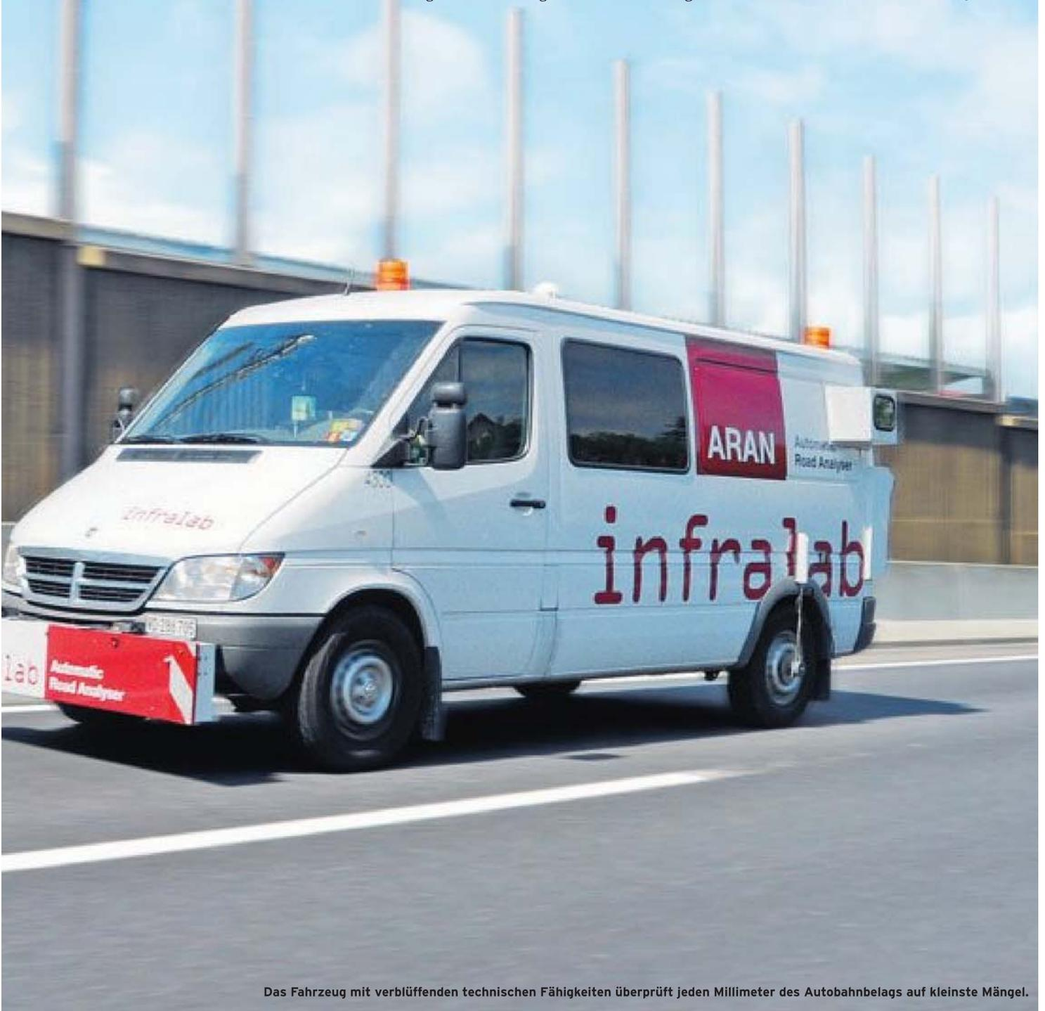
Das Fahrzeug mit verblüffenden technischen Fähigkeiten überprüft jeden Millimeter des Autobahnbelags auf kleinste Mängel.
