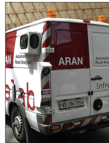
Laser, links neben der Türe, messen Strassenunebenheiten.
