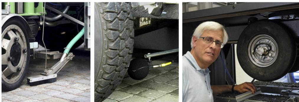
**Das blaue Lärm-Messfahrzeug der deutschen Firma Müller-BBM Planegg. Bei der Griffigkeitsmessung muss das Rad ständig benetzt werden. Bei der Lärmmessung sind vier Mikrofone installiert. Christian Angst, Geschäftsführer der IMP Bautest AG.** Fotos: R. Beck (1), z/Vg (3)
