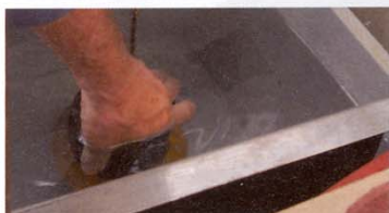
Marshallprobe im Wasserbad
