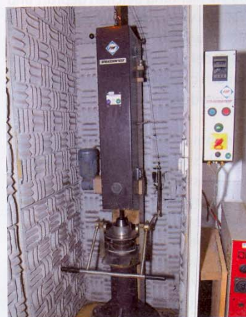
Marshallkörperprobe: Von einer Fallhöhe von 457 mm fällt ein Gewicht von Gramm auf die Probe hinunter
