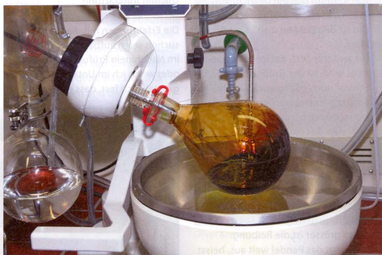
Das Gemisch Bitumen/Lösungsmittel wird in einen Glaskolben geführt und im Ölbad gekocht
