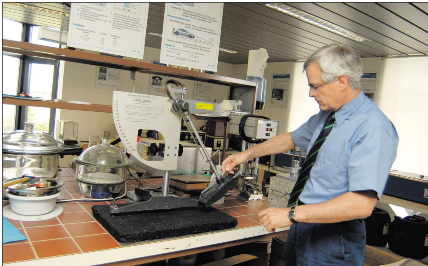
IMP-Bautest-Gründer Christian Angst zeigt, wie man die Griffigkeit von Strassenmarkierungen erfasst.
