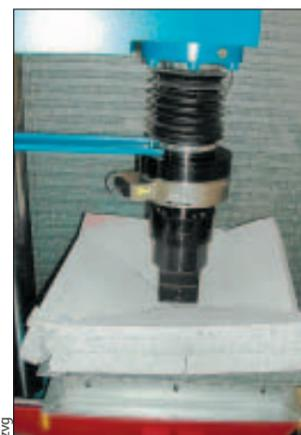
Der Druck war zu gross: Betonplatte im Prüfstand.
