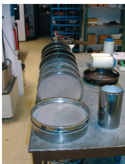
Siebe zur Bestimmung der Korngrössenverteilung.
