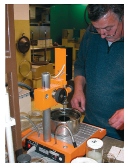
Bitumen: Messen der Penetration (Eindringtiefe).
