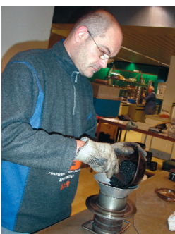
Vorbereitung des Marshallversuchs.
