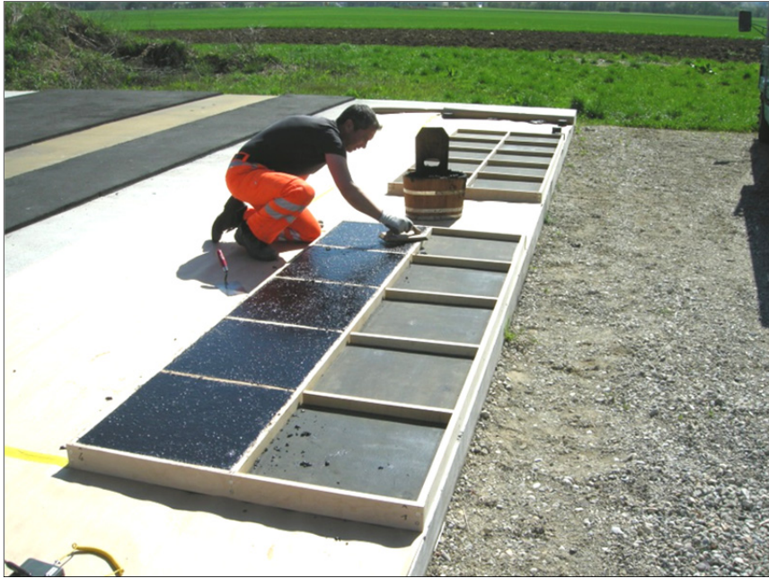
Abbildung 3: Herstellung von Platten 400 x 400 mm mit den verschiedenen Systemen
