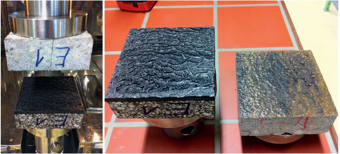
1 | Versuchsaufbau des Zug-Schwellversuches und Fotos der Trennschicht EP-Versiegelung/PBD. 1 | Conception expérimentale de l'essai de traction et photos de la couche de séparation Vitrification époxy/PBD.
