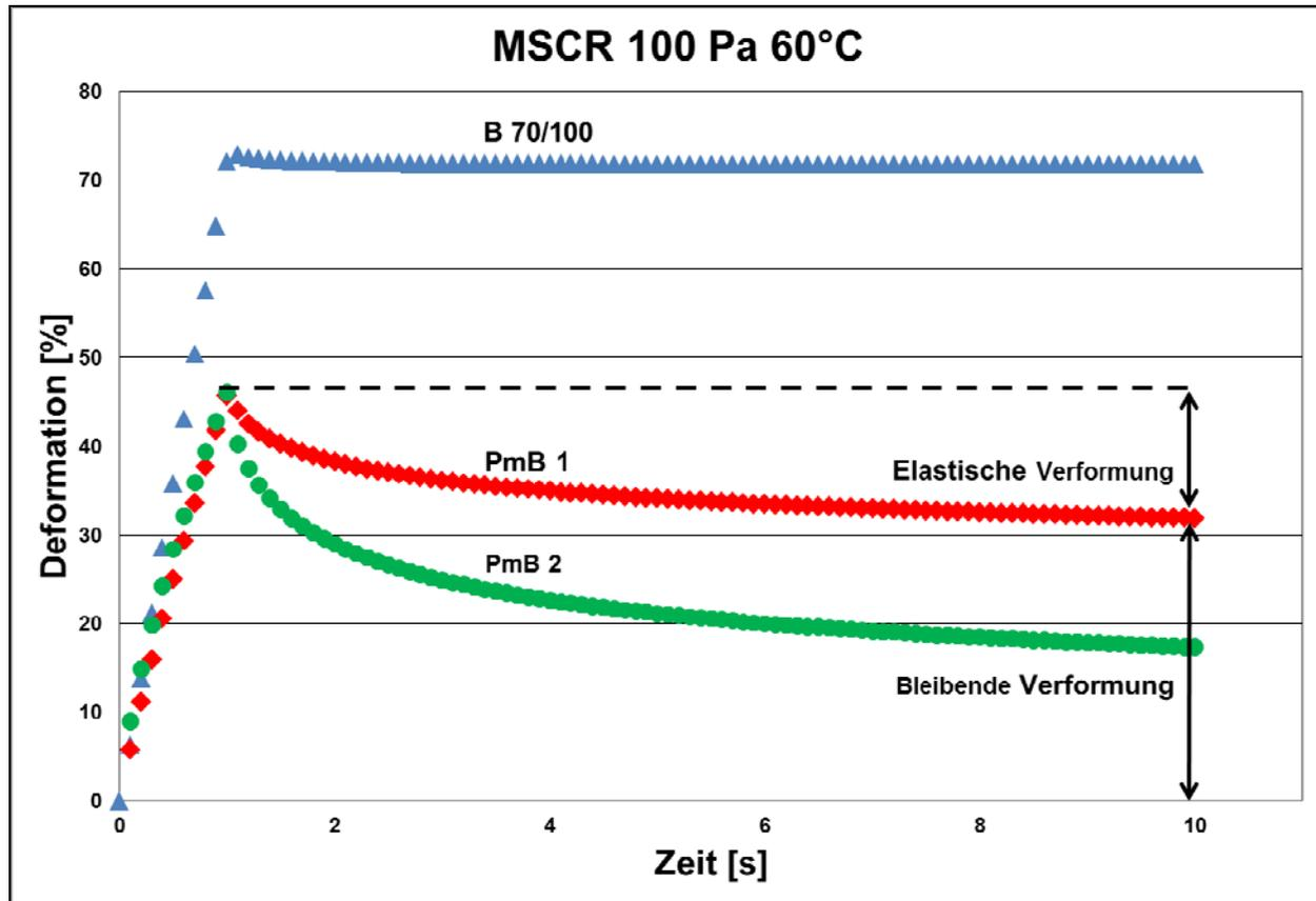
Fig. 2 Comparaison du taux de déformation plastique de différents PmB (source: IMP)
