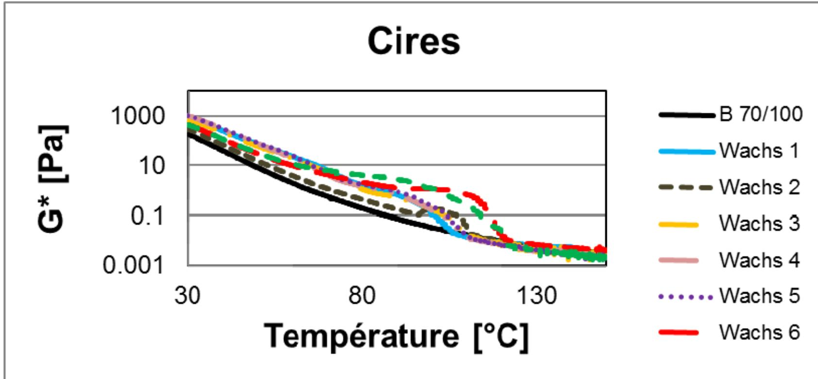
**Fig 1** Comparaison de différents types de cire pour la fabrication d'enrobés à basse température (source: IMP)
