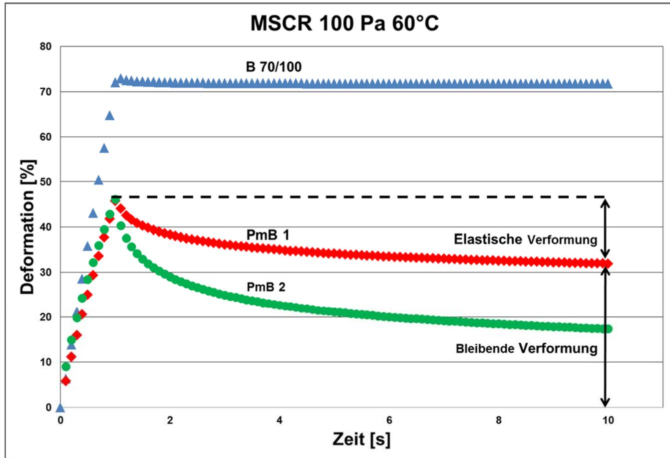
**Abb. 2** Vergleich des plastischen Anteils an der Gesamtverformung verschiedener PmB (Quelle: IMP)
